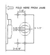
CENTER OF CYLINDER END OF BODY INSIDE FACE OF THE DOOR
