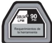
**IMPORTANTE:** para funcionar de manera correcta, esta herramienta necesita un flujo de aire de al menos 209,54 litros por minuto a 90 PSI en la herramienta. El largo de la manguera de aire podría afectar la cantidad de presión de aire que recibe realmente la herramienta. Es posible que deba ajustar la presión de aire más alta en el regulador de aire para lograr la presión de trabajo de 90 PSI.
