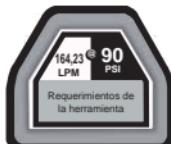
**IMPORTANTE:** para funcionar de manera correcta, esta herramienta necesita un flujo de aire de al menos 164,23 litros por minuto a 90 PSI en la herramienta. El largo de la manguera de aire podría afectar la cantidad de presión de aire que recibe realmente la herramienta. Es posible que deba ajustar la presión de aire más alta en el regulador de aire para lograr la presión de trabajo de 90 PSI.
