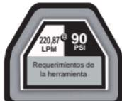
**IMPORTANTE:** para funcionar de manera correcta, esta herramienta necesita un flujo de aire de al menos 220,87 litros por minuto a 90 PSI en la herramienta. El largo de la manguera de aire podría afectar la cantidad de presión de aire que recibe realmente la herramienta. Es posible que deba ajustar la presión de aire más alta en el regulador de aire para lograr la presión de trabajo de 90 PSI.
