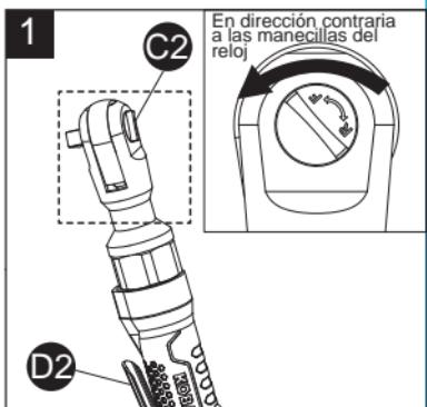
2. Para retirar la tuerca, gire la perilla hacia delante o hacia atrás (C2) en dirección de las manecillas del reloj a la posición de reversa. Presione el gatillo (D2). (Consulte la Figura 2).
