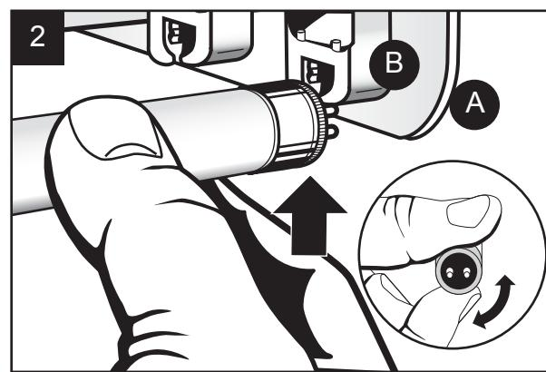
3. Suivez les étapes ci-dessus dans le sens inverse pour installer le nouveau tube. Pour poser le diffuseur (C), alignez les trous situés à l'une des extrémités des embouts (E) avec les boulons à carrosserie qui ressortent. Fixez le diffuseur (C) au luminaire (A) à l'aide des capuchons (BB). Remarque : Deux personnes peuvent être nécessaires pour l'installation du diffuseur (C).
