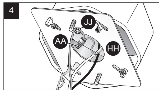
**COFFRET DE BRANCHEMENT MÉTALLIQUE ET MIS À LA TERRE :** Si le coffret de branchement est en métal et qu'il est mis à la terre, faites passer le fil de mise à la terre vert ou en cuivre fixé à l'intérieur du luminaire à travers le centre du luminaire (A), puis fixez-le au support de fixation (HH) à l'aide de la vis de mise à la terre (II).
