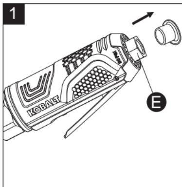
2. Apriete el conector mancho (no se incluye) girando en dirección de las manecillas del reloj con una llave (no se incluye) para una conexión hermética.
