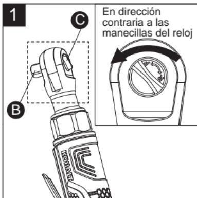
2. Para retirar o aflojar los sujetadores y piezas de trabajo roscados, gire la perilla hacia delante/reversa (C) en dirección de las manecillas del reloj hacia la posición reversa. Presione el gatillo (D). El yunque de la herramienta (B) gira en dirección contraria a las manecillas del reloj y retira y afloja los sujetadores y piezas de trabajo roscados (Consulte la figura 2).
