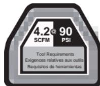
**IMPORTANTE:** para funcionar correctamente, esta herramienta necesita un flujo de aire de al menos 4.2 pies cúbicos estándar por minuto (SCFM, por sus siglas en inglés) a 90 libras por pulgada cuadrada (PSI por sus siglas en inglés) en la herramienta. El largo de la manguera de aire podría afectar la cantidad de presión de aire que recibe realmente la herramienta. Es posible que deba ajustar la presión de aire más alta en el regulador de aire para lograr la presión de trabajo de 90 PSI.
