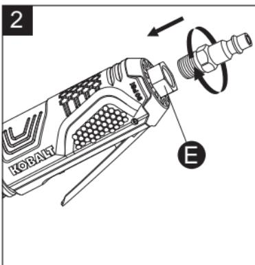
**REMARQUE** Entourez le filetage du connecteur mâle avec du ruban d'étanchéité pour joints filetés (non inclus).
