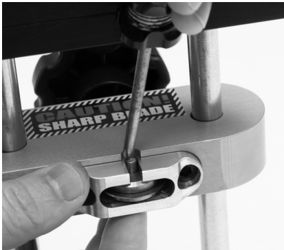
Paso 6 – Utilice un destornillador o un pasador para centrar el pluma de eje.
