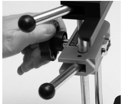
Étape 7 – Tourner le bouton dans le sens inverse des aiguilles d'une montre pour ramener la lame en position de rainage.
