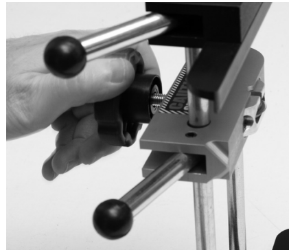
Paso 7 - Gire la perilla en sentido antihorario para devolver la hoja a la posición de marcar.
