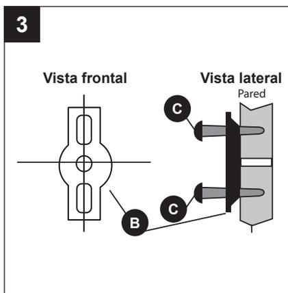
4. Si se fija a un panel de yeso sin una viga de madera, taladre orificios de 6.35 mm en el panel de yeso a través de los orificios para tornillos de montaje en cada soporte de montaje (B). Con un martillo, introduzca cuidadosamente las anclas de expansión para paneles de yeso (A) en los orificios hasta que queden al ras con la superficie de la pared. Ajuste los soportes de montaje (B) en la pared con los tornillos de montaje (C).
