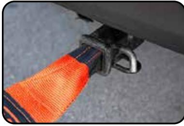
2. Attachez l'autre extrémité de la sangle au véhicule avec lequel vous tirez. De nombreux véhicules ont des crochets ou des boucles que vous pouvez utiliser pour ce faire. Vous pouvez également utiliser un récepteur d'attelage de remorque avec un boulon/une goupille, comme illustré.
