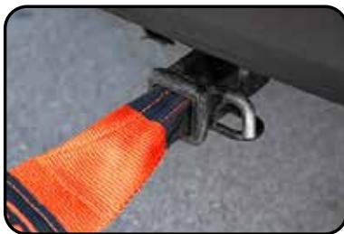
2. Fije el otro extremo de la correa al vehículo que está utilizando para tirar. Muchos vehículos tienen ganchos o bucles que puede usar para hacer esto. También puede usar un receptor de enganche de remolque con un perno / pasador como se muestra.
