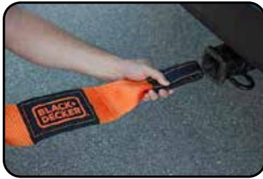
1. Connectez la sangle de récupération à la machine/au véhicule qui est désactivé/bloqué en enfilant l'extrémité de la sangle de récupération dans le crochet de remorquage du véhicule. Certains véhicules ont un emplacement de crochet caché derrière un petit morceau carré de plastique amovible.
