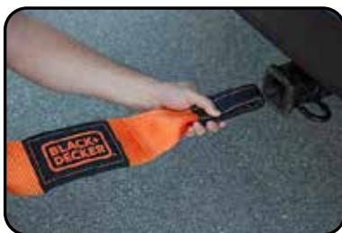
1. Conecte la correa de recuperación a la máquina / vehículo que está desactivado / atascado enhebrando el extremo de la correa de recuperación a través del gancho de remolque del vehículo. Algunos vehículos tienen una ubicación de gancho oculta detrás de una pequeña pieza cuadrada de plástico que se puede quitar.
