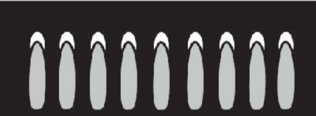
(B) 火焰外锥上有黄色火焰尖端— 丙烷气正常
