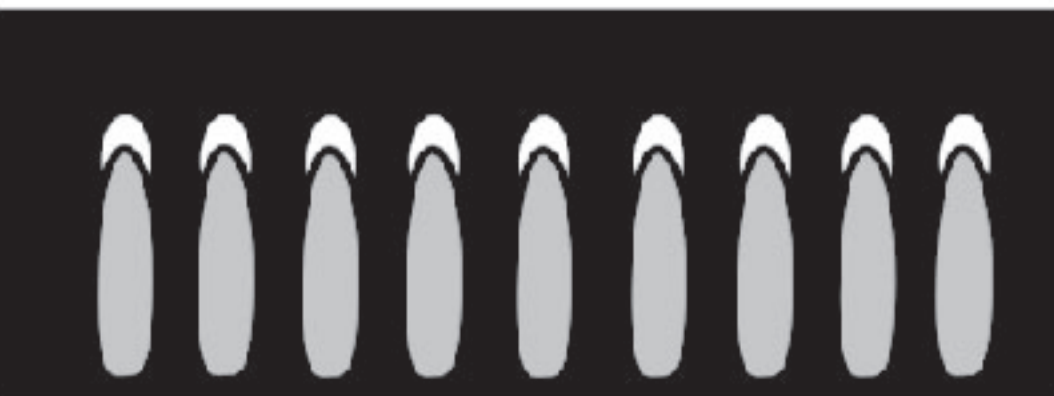
(B) Puntas amarillas en conos exteriores— Normal para gas propano
