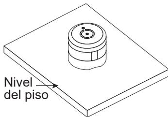
3. Para instalar en el piso o en una superficie plana, vuelva a conectar la parte superior (alarma) y la base (sensor) y colóquela directamente en la superficie, cerca de la zona a monitorear.
