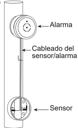
4. Para instalar en una fosa de sumidero, la alarma se puede conservar como una unidad ensamblada (la parte superior y la base unidas) y colocarse en la tubería de descarga de la bomba de sumidero. Si no, se puede separar la base (sensor) y colocarla en la tubería de descarga de la bomba de sumidero. El cable del sensor/alarma de 1.5 m ft) permite colocar la alarma sobre la contenedor para agua de sumidero para una mayor accesibilidad
