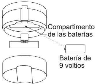
1. Separe la parte superior (alarma) y la base (sensor) de la unidad para acceder al compartimento de la batería.
