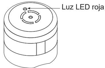
1. La luz LED roja se encenderá y la alarma emitirá un pitido en intervalos de cinco segundos a unos 110 decibeles cuando los sensores entren en contacto con el agua. Para silenciar la alarma, retírela del contacto con el agua y limpie cualquier exceso de humedad. Si esto no hace que la alarma se silencie, sople aire por el sensor para eliminar cualquier humedad restante.
