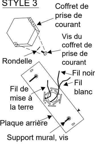
Style 3 Enlevez les vis du coffret de prise de courant. Installez une plaque arrière de pleines dimensions en utilisant les vis fournies avec le coffret de prise de courant et serrez les vis.
