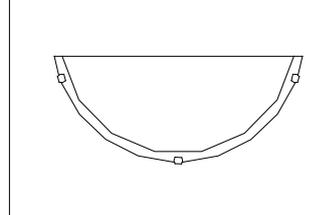
**6:** Une fois les plaques avant et arrière jointes, installez une ampoule de puissance appropriée et mettez le verre en place sur le bras.
