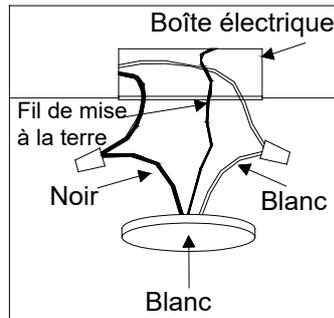
**4:** Passez le fil noir ou rouge, le fil blanc et le fil de mise à la terre par l'ouverture de la plaque arrière. Ensuite, raccordez le fil noir ou rouge du coffret de prise de courant au fil noir du luminaire, puis raccordez le fil blanc du boîtier électrique au fil blanc du luminaire. Raccordez le fil de mise à la terre du coffret de prise de courant au fil de mise à la terre du luminaire.
