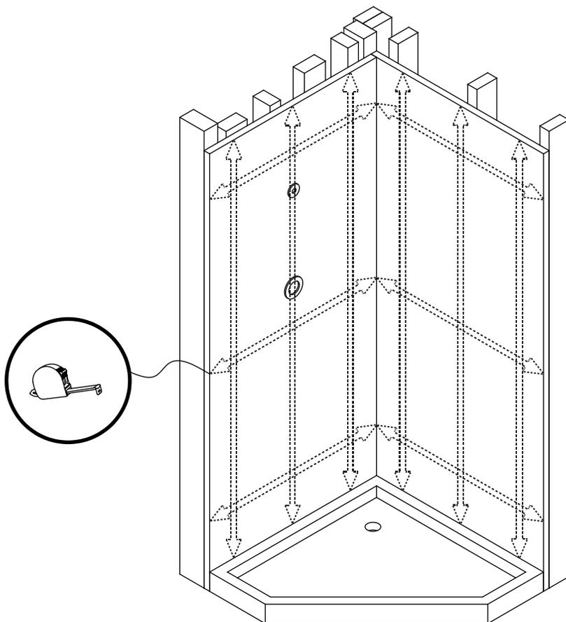
3. Mide las ubicaciones de los recortes para los accesorios de plomería y márcalos en la parte posterior de los paneles apropiados.
