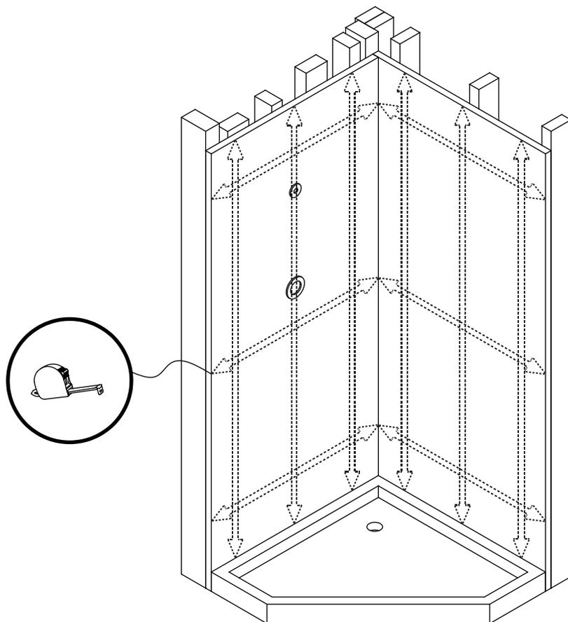
3. Mesurez les emplacements de découpe pour les éléments de plomberie et marquez-les au dos du/des panneau(x) approprié(s).
