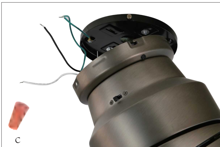
Paso 4 Cuelgue el motor en el gancho en J del soporte de montaje y conecte el receptor al circuito doméstico. Negro para Live Wire, Blanco para el cable neutro, verde para el cable de tierra.
