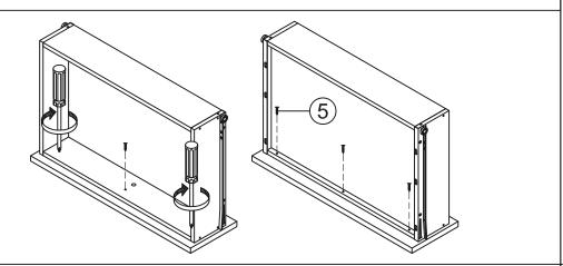
**STEP 17** PULL THE DRAWER OPEN SLOWLY AND RE-TIGHTEN THE SCREWS FROM STEP 14. MAKE SURE THE FRONT PANEL DOES NOT MOVE AND LOCK THE DRAWER FRONT PANEL INTO POSITION WITH 3/4" FLAT HEAD SCREWS.
