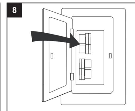
Restore the power at the main fuse or circuit breaker./Rétablissez l'alimentation électrique depuis le panneau central de disjoncteurs ou de fusibles./Restablezca la alimentación en el fusible principal o el interruptor de circuito.
