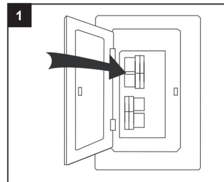
Turn OFF the electrical power at the main fuse or circuit breaker./COUPEZ l'alimentation électrique à partir du panneau central de disjoncteurs ou de fusibles./Corte la alimentación eléctrica del fusible principal o el interruptor de circuito.
