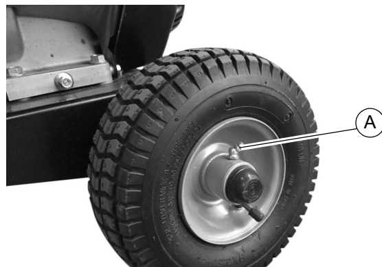
Figura 4-3. Engrase de los cojinetes de las ruedas
