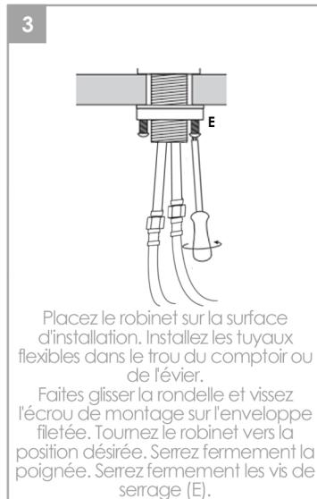
Placez le robinet sur la surface d'installation. Installez les tuyaux flexibles dans le trou du comptoir ou de l'évier. Faites glisser la rondelle et vissez l'écrou de montage sur l'enveloppe filetée. Tournez le robinet vers la position désirée. Serrez fermement la poignée. Serrez fermement les vis de serrage (E).
