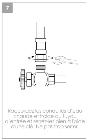
Raccordez les conduites d'eau chaude et froide au tuyau d'entrée et serrez-les bien à l'aide d'une clé. Ne pas trop serrer.
