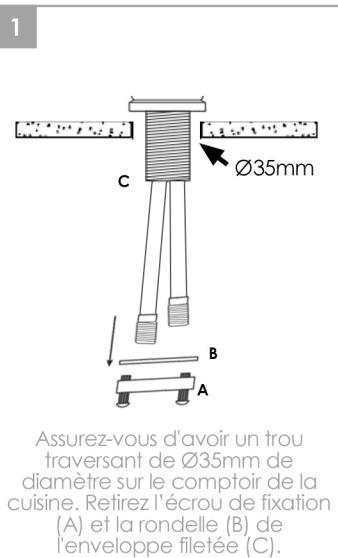
Assurez-vous d'avoir un trou traversant de Ø35mm de diamètre sur le comptoir de la cuisine. Retirez l'écraveuse de fixation (A) et la rondelle (B) de l'enveloppe filetée (C).
