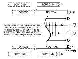
NEUTRAL BUS FOR PLUG-ON NEUTRAL CIRCUIT BREAKERS
