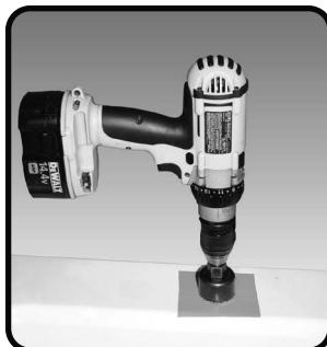
Paso 3 - Realice el orificio grande con una sierra de perforación con punta de diamante de 1/2". Mantenga el taladro en velocidad mínima y use aceite lubricante o jabón líquido para mantener la sierra de perforación fría durante el proceso de corte.
