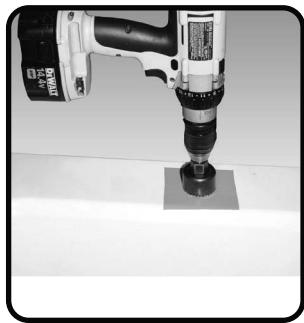
Étape 3 - À l'aide d'une scie-cloche diamant de 1/2 po, percez le grand trou. Percez en restant sur la vitesse la plus lente et utilisez de l'huile de graissage ou du savon liquide pour que la scie-cloche reste froide pendant l'opération.
