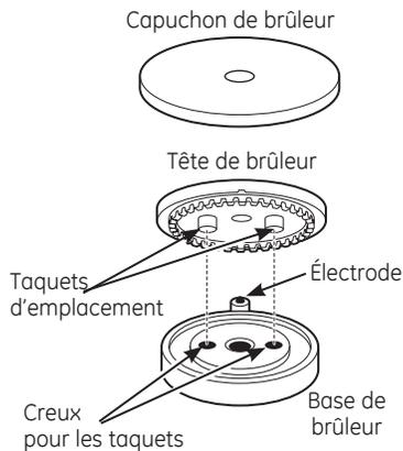
Assurez-vous que les taquets de brûleur correspondent aux creux de la base de brûleur et qu'ils soient bien installés dans ces creux en faisant tourner les têtes jusqu'à ce qu'elles soient bien horizontales.
