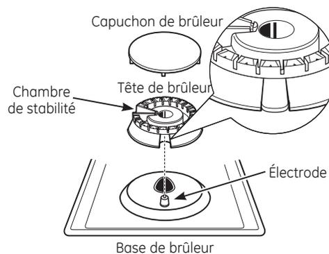
Assurez-vous que la fente de la tête de brûleur soit placée sur l'électrode. Le capuchon de brûleur a trois ou quatre taquets. Quand vous remettez le capuchon en place, assurez-vous qu'aucun taquet ne repose dans la chambre de stabilité.
