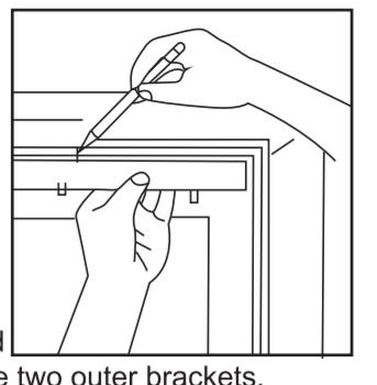
Remarque : Le troisième support doit être placé au milieu, à égale distance de ceux des extrémités.
