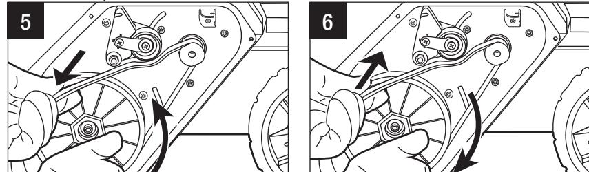
5. Utilisez une pince à bec effilé (non fournie) pour installer le ressort sur le crochet afin de tendre la courroie d'entraînement (Fig. 3).
