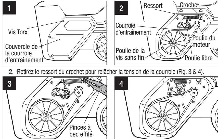
2. Retirez le ressort du crochet pour relâcher la tension de la courroie (Fig. 3 & 4).
