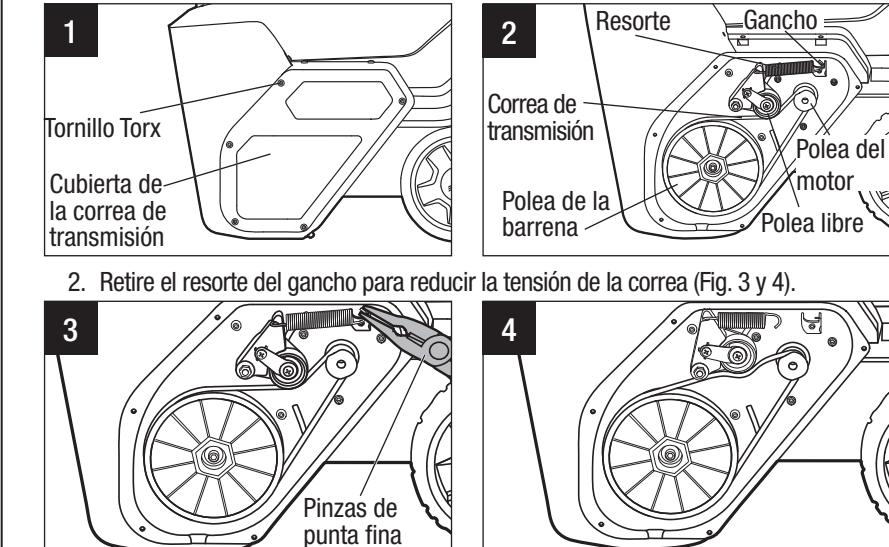
2. Retire el resorte del gancho para reducir la tensión de la correa (Fig. 3 y 4).
