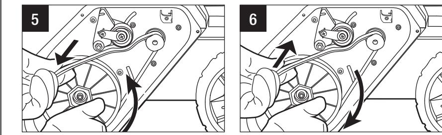
5. Utilice unos alicates de punta fina (no incluidos) para instalar el resorte en el gancho con el fin de tensar la correa de transmisión (Fig. 3).
