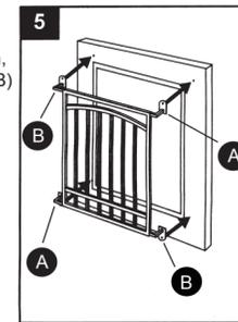
5. Pretaladre los orificios con una broca para taladro de 3/16 pulg y coloque la barra de la ventana en posición, alineando las abrazaderas (A) y (B) con los orificios pretaladrados.
