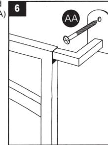
6. Fije cada abrazadera (A) y (B) con los tornillos de una vía (AA) usando el destornillador de una vía.
