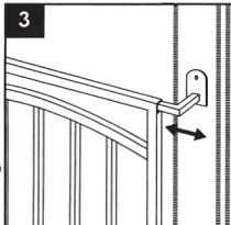
3. Coloque las abrazaderas (A) y (B) jalándolas hacia adentro y hacia afuera del marco de la barra de la ventana hasta que estén centradas sobre las vigas de 2' x 4'
