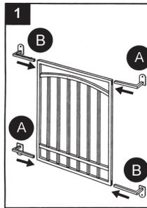
1. Inserte las abrazaderas (A) y (B) en las barras horizontales de la unidad de barra de la ventana (no se incluye) como se muestra. Las lengüetas de las abrazaderas superiores deben apuntar hacia arriba y las lengüetas de las abrazaderas inferiores deben apuntar hacia abajo.
