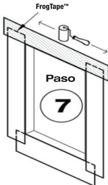
Figura 8 Aplique el tapajuntas de cabezal.
