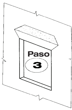
Figura 4 Corte la solapa del cabezal de la WRB y dóblela hacia arriba.
