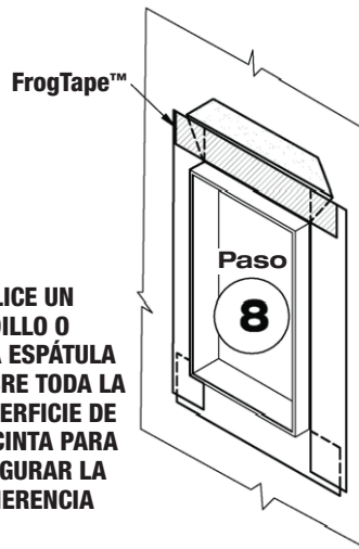
Figura 7 Instale la ventana en la abertura tapajuntas.
