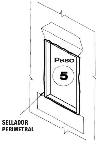
Figura 6 Aplique sellador perimetral.
