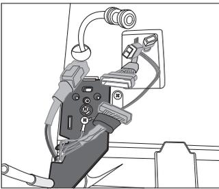
2. Coloque la bisagra superior sobre los orificios de montaje y alinee a la posición correcta antes de apretar. Use un extremo de caja de 10 mm o una llave de tubo para girar la parte superior bisagra en sentido horario para asegurar la bisagra. Vuelva a conectar de forma segura el arnés de cables.
