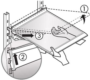
**Para reinstalar una repisa:** Con El frente de la repisa ligeramente angulado hacia arriba , enganche los ganchos en la parte posterior en las ranuras de fijación de la repisa, y a continuación baje la repisa en posición.
