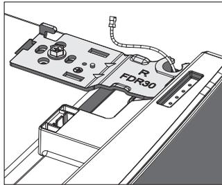
3. Atornillar la bisagra superior en posición con un destornillador.
