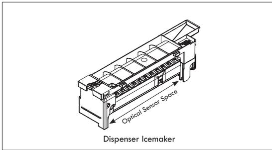
La fabricación de hielo se detendrá cuando el depósito de hielo del dispensador se llene al nivel del sensor óptico, o cuando el depósito de hielo del congelador se llene y empuja el brazo de cierre hacia arriba.
