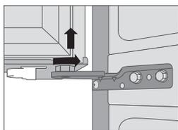
2. Para bajar la puerta del refrigerador girar el tornillo en hacia la derecha.
