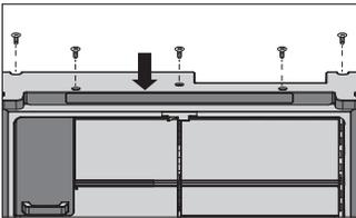
3. Atornillar la bisagra superior en posición con un destornillador.
