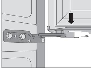
2. Coloque la bisagra superior en los agujeros del montaje y alinee a la posición correcta antes de apretar, gire la bisagra superior hacia la derecha para fijar la bisagra.
