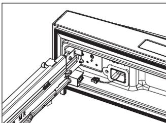
3. Utilice una llave de tubo o extremo abierto de 10 mm para quitar el perno que conecta el riel a cada lado del cajón fascia. Inclíne la fascia hacia arriba y retírela de los rieles.
