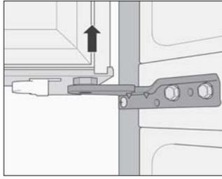
**NOTA:** Si es necesario para poder mover la unidad a través de una puerta o pasillo estrecho, retire las bisagras centrales de la puerta izquierda y derecha. Use una llave de 10 mm para aflojar y quitar los dos pernos que sujetan la bisagra al gabinete.
