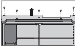
2. Usando una llave de tubo o extremo de caja de 10 mm, gire la bisagra superior sujetador en sentido antihorario para quitar la placa de la bisagra superior. Desconecte el mazo de cables.
