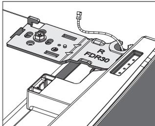
3. Levante la puerta de la bisagra del medio y retire la puerta. Coloque la puerta, con el interior hacia arriba, sobre una superficie que no arañe.
