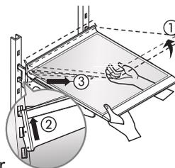
Para reinstalar una repisa: Con El frente de la repisa ligeramente angulado hacia arriba, enganche los ganchos en la parte posterior en las ranuras de fijación de la repisa, y a continuación baje la repisa en posición.
