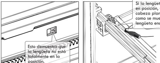
Si la lengüeta no está completamente en posición, utilice un destornillador de cabeza plana para empujar en el carril como se muestra, para permitir que la lengüeta encaje en su posición.
