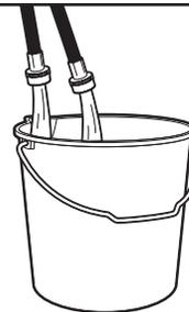
Laisser s'écouler l'eau des deux robinets et des tuyaux d'alimentation dans un évier de buanderie, un tuyau de rejet à l'égout ou un seau, pour éliminer les particules se trouvant dans les canalisations d'eau.
