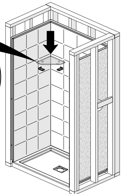
Insérer les capuchons (5) dans les rondelles (4). Aligner les trous de la tablette en ceux des supports (2), puis y insérer l'assemblage du capuchon (5). Sous la tablette, insérer les vis #10 x 1/2 po (6) et serrer avec la clé hexagonale (7).
