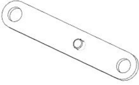
F03 LINKAGE STRAP - A4M02229 (x1) 1/2"x11/16"x3 13/16" (13x17x97)
