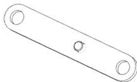
F03 LINKAGE STRAP - A4M02229 (x1) 1/2"x11/16"x3 13/16" (13x17x97)
