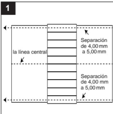
2. Primera fila. Coloque un panel (1) como soporte para la alineación del lado largo de los paneles (2) y (3) mientras instala estos últimos. Después de instalar la primera fila completa, retire el panel (1).
