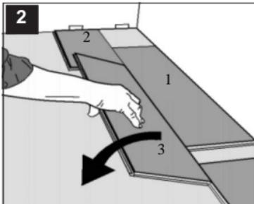
3. Segunda plancha, primera fila. Coloque esta plancha (3) con cuidado cerca del extremo corto de la primera (2).
