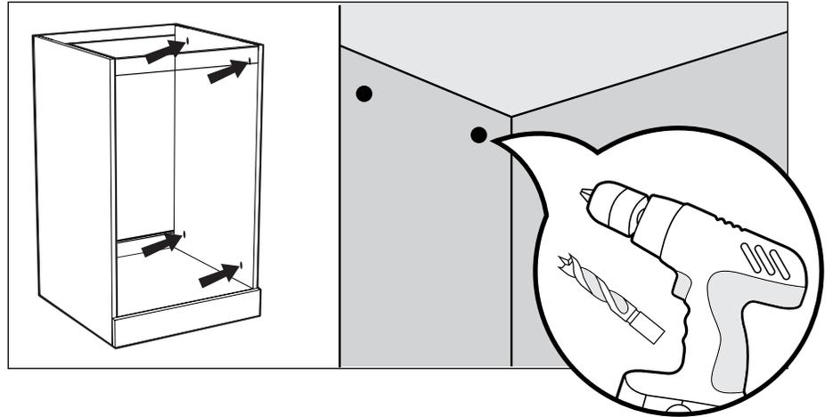
**2** Visser la deuxième armoire en se servant des pré-trous comme guides. Ne pas trop serrer les vis, elles risqueraient de ressortir de l'autre côté!
