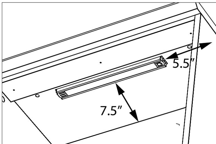
2 Faire passer le câble du connecteur à travers les trous prépercés sur les parties supérieures de l'armoire et les connecter aux extrémités des bandes lumineuses à DEL.
