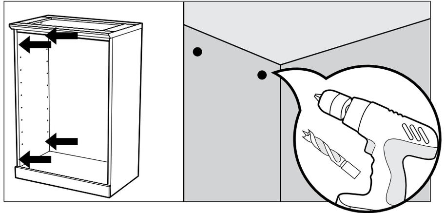
**2** Visser la deuxième armoire en se servant des avant-trous comme guides. Ne pas trop serrer les vis, elles risqueraient de ressortir de l'autre côté!
