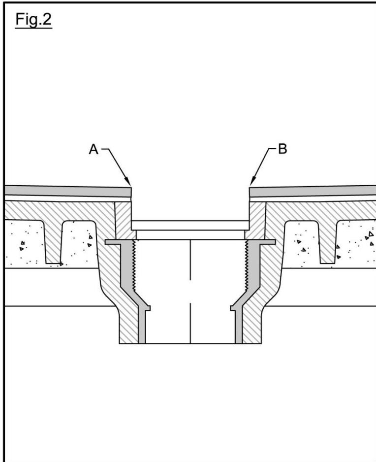
**III. COMMENT INSÉRER LA GRILLE DE DRAIN SOLIDE ÊTRE COUVERTE DE CARREAUX DANS LE RECEVEUR DE DOUCHE COUVERT DE CARREAUX AFIN QUE (A) ELLE SOIT ESPACÉE CORRECTEMENT POUR LE DRAINAGE ET (B) ELLE SOIT AU MÊME NIVEAU QUE LE CARRELAGE ADJACENT: (Voir les Figs. 1 & 3)**
