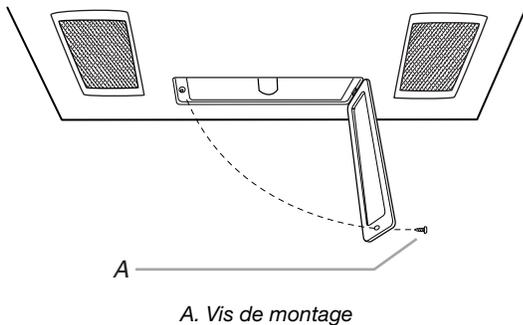
3. Remplacer l'ampoule. Rabattre le couvercle. Réinstaller la vis de montage.
