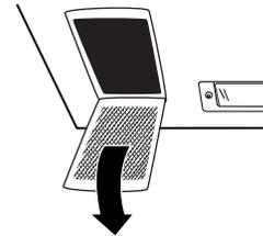
2. Remise en place des filtres à graisse : Insérer l'une des extrémités du filtre dans le bord arrière du cadre. Redresser l'extrémité avant du filtre vers le haut puis le faire glisser vers l'avant jusqu'à insertion complète.
