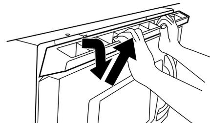
3. Faire légèrement glisser le filtre vers l'arrière, soulever l'extrémité avant et tirer le filtre.
