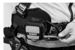
Ahora conectar las correas de gancho y el lazo adecuadamente. Insertar el gancho de acero inoxidable provisto en la parte posterior del soporte para cinta en el cinturón del arnés o cualquier otro cinturón colocado en la cintura.
