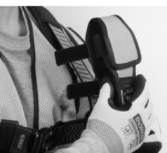
Dérouler les deux bandes à boucles et à crochets fournies sur la bande de la pochette mobile. Attacher la bande de sac mobile à la sangle du harnais à l'endroit de votre choix.
