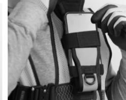
Para sujeción adicional de la herramienta, conectar la eslinga herramientas al anillo en D de plástico proporcionado en la banda de la bolsa para radio/ teléfono móvil.
