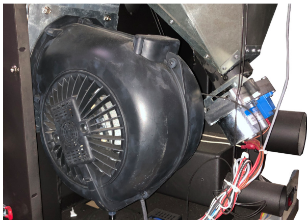
Figure 26 Ventilateur d'échangeur d'air chaud du modèle PSBF66W
