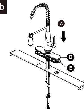
2. Desde la parte inferior del fregadero, asegure el ensamblaje del grifo (A) al fregadero con la tuerca de instalación rápida (B). Presione la tuerca de instalación rápida (B) hacia arriba sobre las roscas hasta que se detenga al alcanzar la parte inferior del fregadero, luego apriete a mano (en dirección de las manecillas del reloj) para apretarla (Fig. 1).
