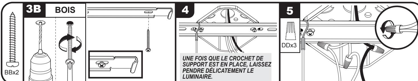
**3B** **Bois:** Localisez les orifices ouverts en vue du montage dans les coins de la plaque de montage et percez un trou pilote de 0,32 cm au centre. Si vous rencontrez un montant en bois, utilisez des vis à bois (**BB**) fournies pour assujettir la plaque de montage directement sur le montant.
