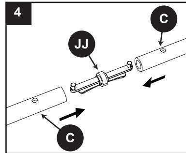
Conecte la varilla (C) al insertar el conector de la varilla (JJ) en las dos piezas de la varilla (C).
