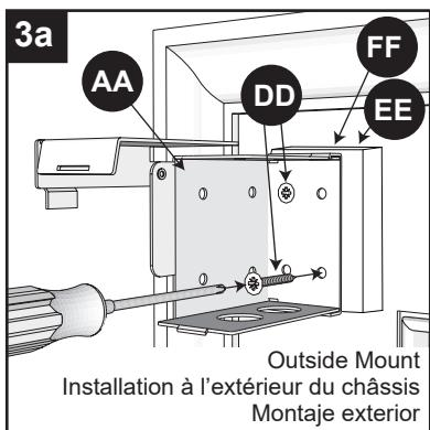
Retirez les supports de fixation (AA) du store (A), alignez les marques de crayon et, à l'aide de grande vis (DD), fixez le store au cadre de la fenêtre latérale ou au mur.
