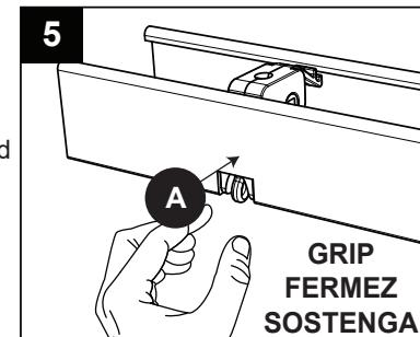
Instale la varilla(C) SOSTENIENDO Y JALANDO el dispositivo para inclinar la varilla ubicado a la izquierda del cortinero de la persiana (A) y enganche la varilla (C) en el dispositivo para inclinar la varilla.
