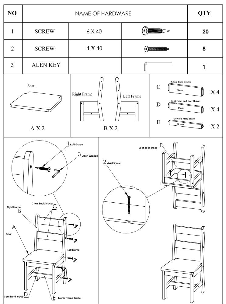
DO NOT TIGHTEN SCREWS BEFORE ADJUSTING STABILITY
