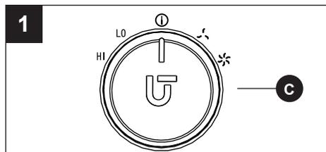
2. Seleccione una configuración de calor o ventilador girando el selector de modo en el panel de control (C) a la posición "LO", "HI", "🌀" o velocidad del "🌀".
