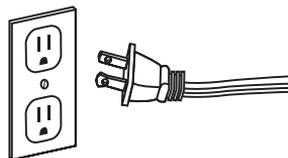
**▲ ADVERTENCIA:** es normal que el cable de alimentación se sienta caliente al tacto. Sin embargo, si el enchufe está flojo en el tomacorriente, es posible que el enchufe se sobrecaliente. Si esto ocurre, intente insertar el enchufe en un tomacorriente diferente. Póngase en contacto con un electricista calificado para que revise si el tomacorriente original presenta daños.
