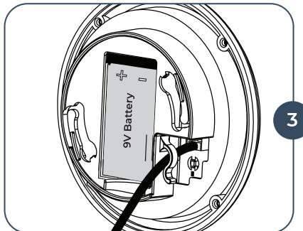
**Installez la pile** dans la face de la serrure. Vous entendrez deux bips lorsque la pile est correctement installée.
