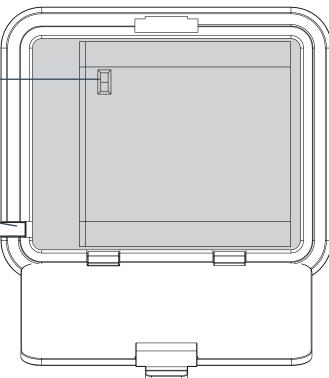
**Mettez le bloc-piles en position « On ».** Cliquer sur le couvercle pour le mettre en place. Votre éclairage est maintenant actif.
