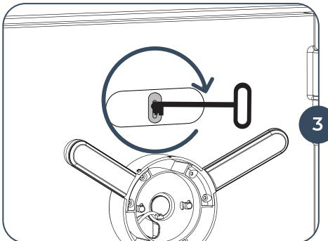
**Insérez la clé dans l'ouverture et tournez-la dans le sens des aiguilles d'une montre.**
