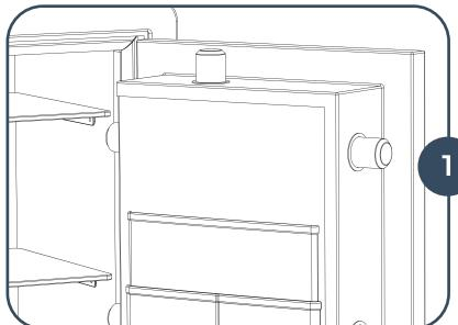
La porte étant ouverte, **sordez les boulons en tournant la poignée dans le sens inverse des aiguilles d'une montre**.
