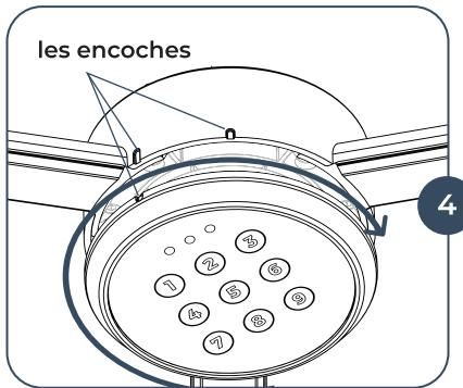
**Alinez les encoches** sur la gauche de la face arrière de la serrure, poussez et tournez dans le sens des aiguilles d'une montre jusqu'à ce que vous sentiez qu'il s'enclenche au niveau de l'encoche centrale.
