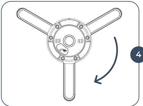
**Tournez les poignées dans le sens des aiguilles d'une montre pour déverrouiller le coffre-fort et ouvrir la porte.**
