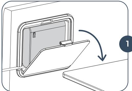
À l'intérieur du coffre-fort, repérez le **compartiment à piles** dans le coin supérieur gauche. Retirez le couvercle pour exposer le bloc-piles à l'intérieur.
