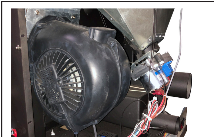
Figure 26 Ventilateur d'échangeur d'air chaud du modèle PSBF66W
