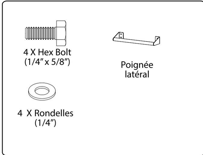
**1** Déterminez de quel côté installer la poignée latérale, la poignée latérale doit être installée du même côté que les roulettes avec freins.
