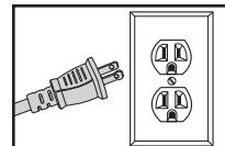
El doble aislamiento elimina la necesidad de un cable de corriente trifilar con toma a tierra y de un sistema de suministro de alimentación con toma a tierra. Esto solo es aplicable a herramientas de Clase II (doble aislamiento). Esta herramienta eléctrica cuenta con doble aislamiento.
