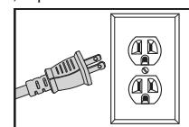
La double isolation élimine le besoin d'un cordon d'alimentation à trois lames et d'une source d'alimentation mise à la terre. Cette règle s'applique uniquement aux outils de classe II (à double isolation). Cet outil motorisé est un outil à double isolation.
