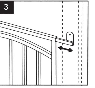
3. Coloque las abrazaderas (A) y (B) jalándolas hacia adentro y hacia afuera del marco de la barra de la ventana hasta que estén centradas sobre las vigas de 2' x 4'.
