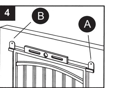
4. Asegúrese de que la barra de la ventana permanezca centrada y uniforme, utilizando el nivel antes de marcar los orificios en los que va a taladrar.
