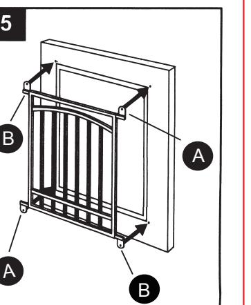
5. Pretaladre los orificios con una broca para taladro de 3/16 pulg y coloque la barra de la ventana en posición, alineando las abrazaderas (A) y (B) con los orificios pretaladrados.
