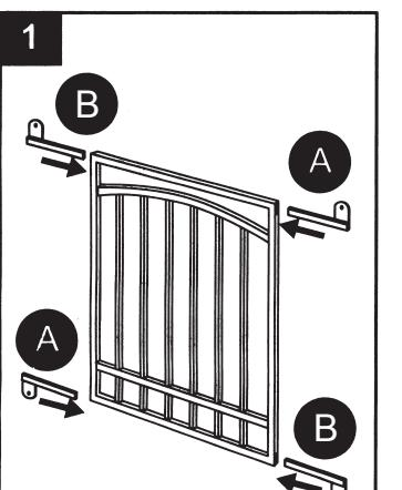
1. Inserte las abrazaderas (A) y (B) en las barras horizontales de la unidad de barra de la ventana (no se incluye) como se muestra. Las lengüetas de las abrazaderas superiores deben apuntar hacia arriba y las lengüetas de las abrazaderas inferiores deben apuntar hacia abajo.
