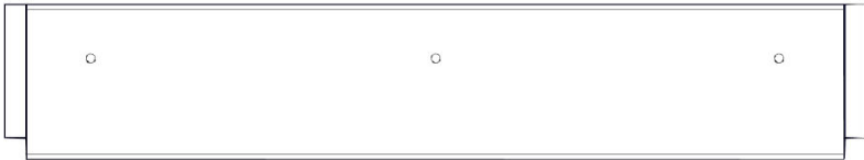
E17 FAN FRAME - W4L20614 (x1) 1 7/16"x3 3/8"x18 11/16" (36x86x475)
