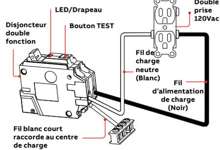
**REMARQUE** : La prise de sortie neutre sur les eMCB (AFCI, GFCI et DFCI) peut être coupée ou rallongée sur site à l'aide de connecteurs agrés. De plus, les eMCBs avec des conducteurs neutres plus courts peuvent être installés comme sur l'illustration pour une installation rapide et sans encombre.
