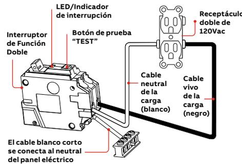
**NOTA:** El cable neutral embobinado de los cortacircuitos electrónicos (AFCI, GFCI, y DFCI) puede ser cortado a medida durante la instalación, o extendido usando conectores aprobados. Además, los cortacircuitos electrónicos con cables neutrales acortados pueden ser instalados de la forma mostrada en el diagrama de conexiones para una instalación más rápida y ordenada.
