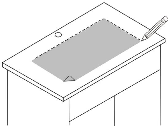
Placez le gabarit de découpe dans la position souhaitée sur le comptoir, en plaçant le centre de la cuvette au-dessus du meuble.
