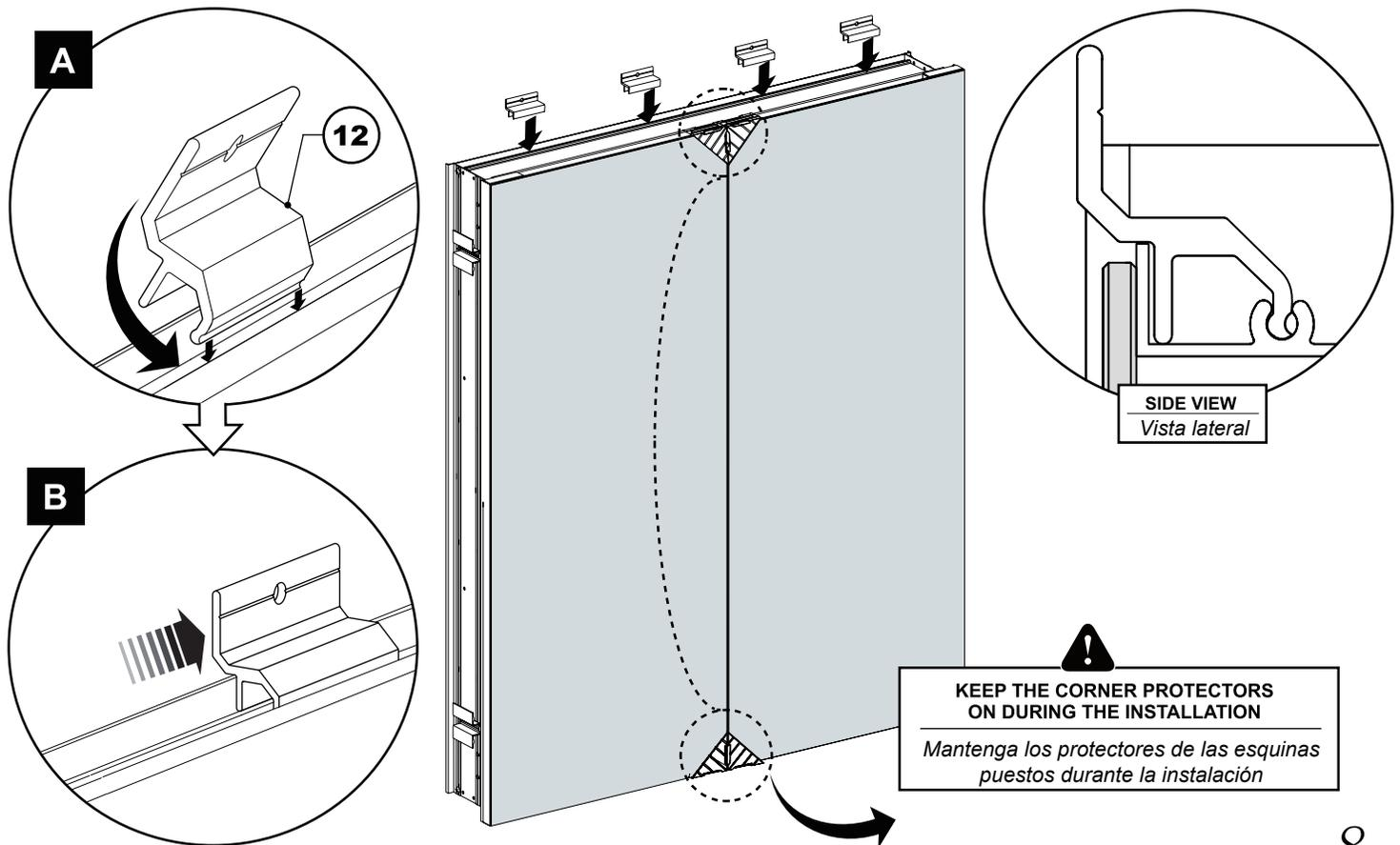
**7** PLACE THE CABINET ON THE WALL / COLOCAR EL ARMARIO EN LA PARED
