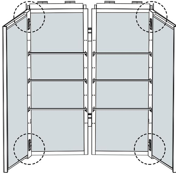
**A** ADJUST THE GAP BETWEEN DOOR AND CABINET / *Ajustar el espacio entre la puerta y el armario*
