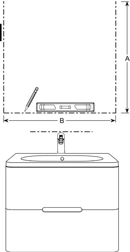
**2 MARK THE BOTTOM SUPPORT ON THE WALL / MARCAR EL S OPORTE INFERIOR EN LA PARED**
