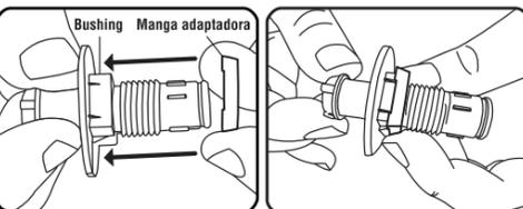
3B Si el tanque tiene un agujero grande para la palanca y el montaje de la palanca parece suelto, coloque la manga adaptadora opcional sobre el montaje de la palanca y sobre el bushing cuadrado. (Manga Adaptadora esta empaquetad suelta)
