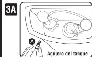
3A Empuje el montaje de la palanca a través del agujero del tanque desde el exterior del tanque hasta que encaje firmemente contra el tanque, pero no lo fuerce.
