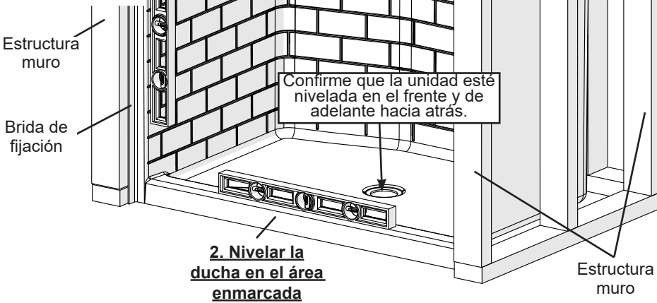
Figura 2b - Procedimiento de instalación de la unidad
