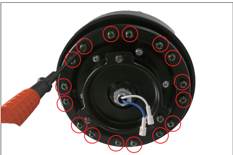
Paso 13 Retire los tornillos utilizados para montar las cuchillas.
