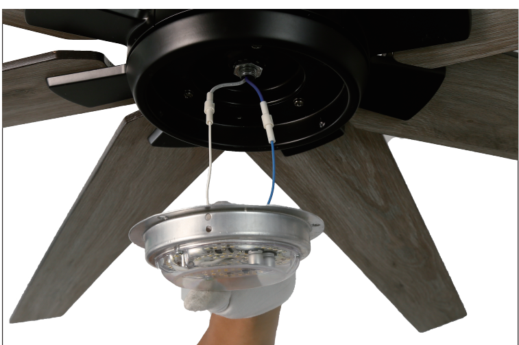
Paso 18 Conectar el cable de alimentación de la luz. Blanco con Blanco, Azul con Azul.
